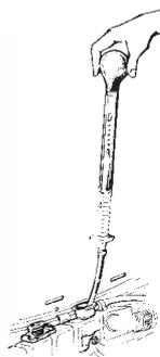
Per verifica e ripristino della miscela anticongelante a base di glicoli etilenici. Strumento di uso facile e veloce, consente di determinare il punto di congelamento della miscela acqua/antigelo presente nel radiatore e di ripristinare quindi il grado di protezione desiderato.
