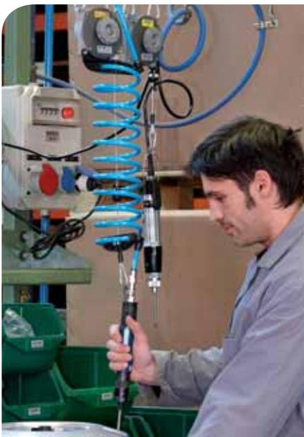
Tubo spiralato (PA12) 8 x 10 per bilanciatori. Questo utile accessorio può essere applicato sui bilanciatori art. 630, 631 e 632. Viene fornito con istruzioni di montaggio, tutti gli accessori e 1 mt. di tubo supplementare per il collegamento alla rete aria compressa ed all'utensile.
